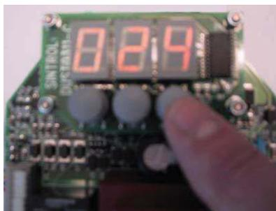
Figure 10. Changing the output scale parameter
